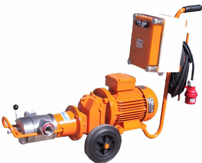
Phönix mit Frequenzantrieb und int. Funkfernsteuerung
