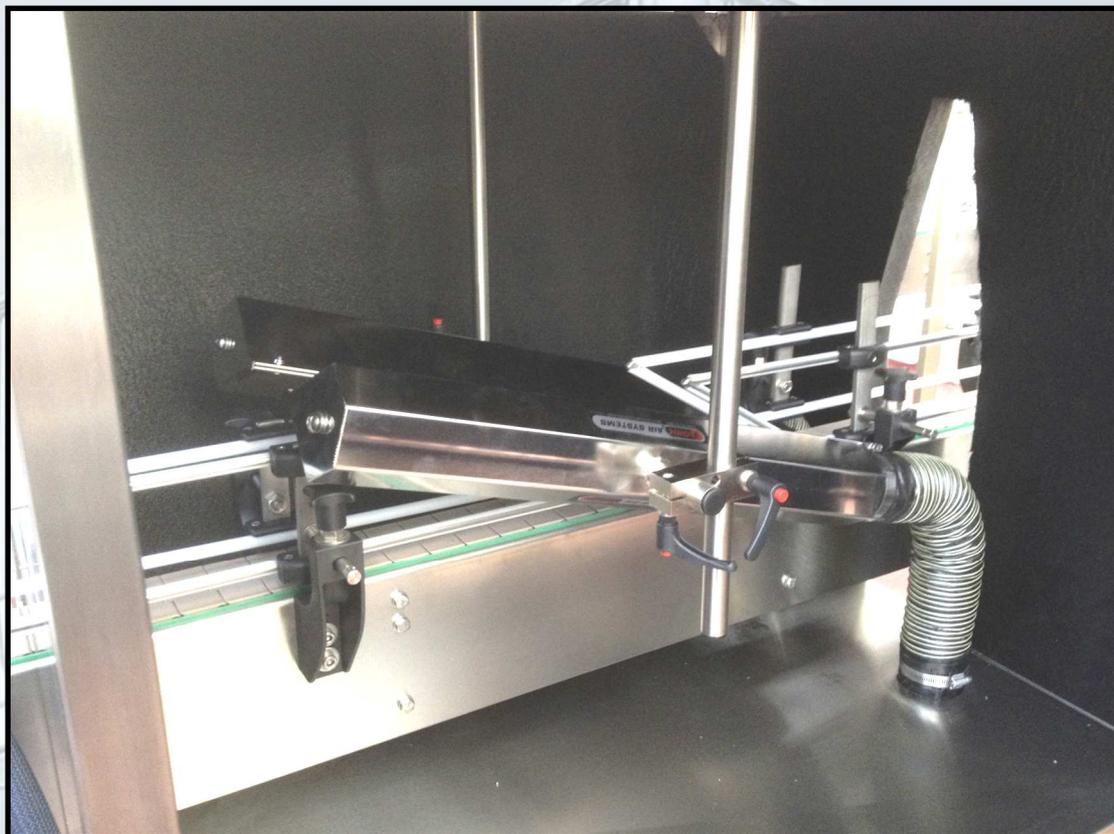
Trockensystem mit leistungsfähige und hochwertige Gebläse, versorgt durch V2a-Messerdüsen, mit einem hervorragenden Wirkungsgrad, um die Feuchtigkeit auf Gefäße zu entfernen.
