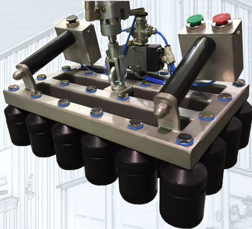
Flaschengreiferkopf, für Aus - und Einpackung von Kartons oder Kisten.
