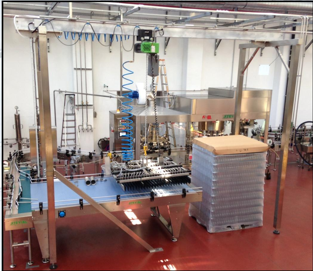
Der Schlauchgreiferkopf ist komplett aus Edelstahl gebaut.
