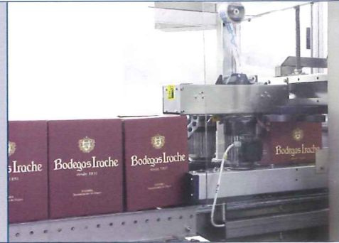
Unità di nastatura per chiusura delle falde superiori ed inferiori Taping unit for upper and lower edges sealing Unité d'application de ruban pour la fermeture des bords supérieurs et inférieurs
