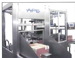
Magazzino cartoni con capacità fino a 75 pz. Cartons store with a capacity up to 75 pieces Magasin cartons avec capacité jusqu'à 75 pièces
