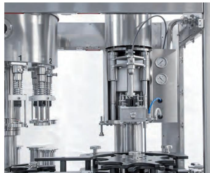
90% di ossigeno in meno) ed inietta gas inerte, così che la bottiglia arrivi alla fase di riempimento satura di gas assolutamente non dannoso per il prodotto, riducendone drasticamente il rischio di ossidazione. Il design di questa nuova deaerazione è decisamente più accattivante rispetto alla precedente e soprattutto ne facilita nettamente la regolazione in altezza, che avviene tramite volantino per un rapido passaggio da un formato all'altro.
